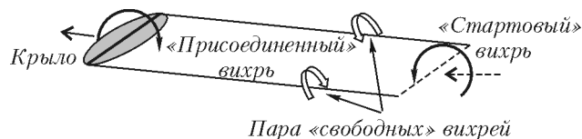
Рис.2. Вихревая схема крыла в первом приближении
